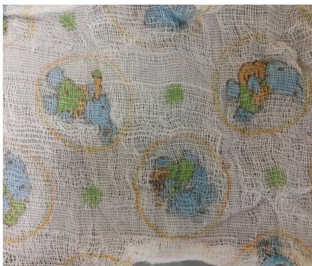
Conforme observa-se, os itens 01 e 04, acima expostos, não possuem informações sobre o fabricante responsável, bem como sobre a composição do material utilizado na fabricação. Constatase, ainda, a ausência de costuras ou acabamentos que evitem deformações nas extremidades dos itens.
